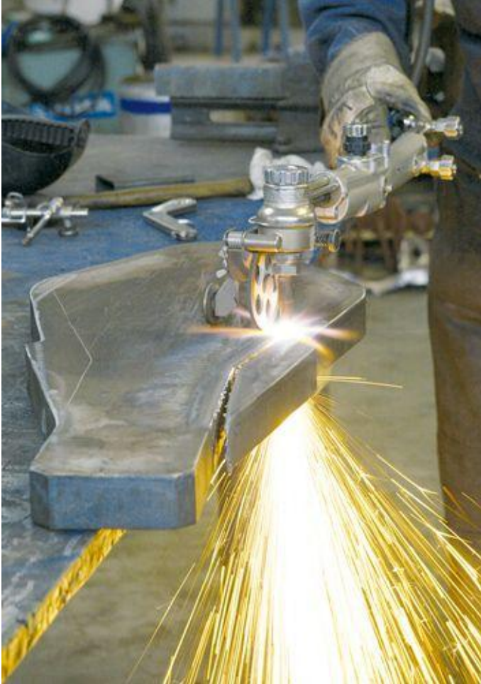
Figuur 7-6: Met een 'wagentje' heb je altijd de juiste afstand.
