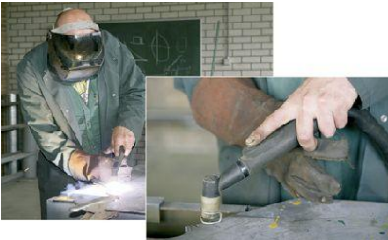
Figuur 7-8: Het werken met de plasmasnijder in de praktijk
